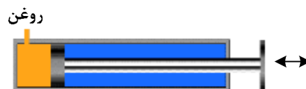
شکل 3-5: محرک هیدرولیکی سیلندر و پیستونی از نوع یک طرفه
